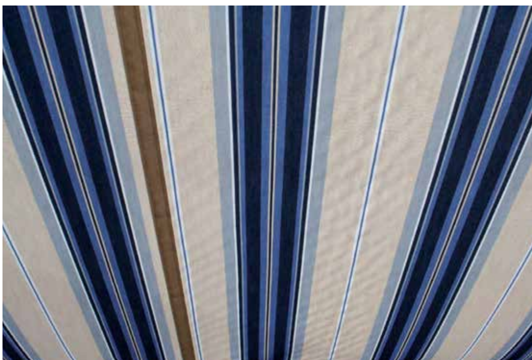
Bild 9.1.10 Tillåten vågighet i banan (bikakebildning)
